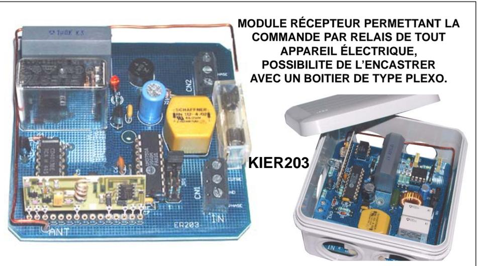
MODULE RÉCEPTEUR PERMETTANT LA COMMANDE PAR RELAIS DE TOUT APPAREIL ÉLECTRIQUE, POSSIBILITE DE L'ENCASTRER AVEC UN BOITIER DE TYPE PLEXO.
