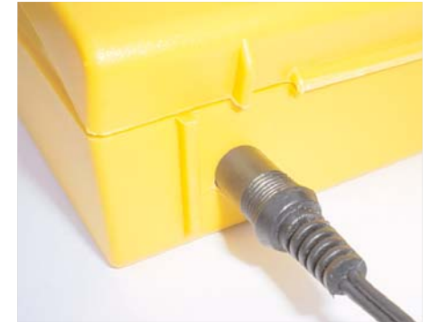
FIGURE 10 : percement du trou d'alimentation
